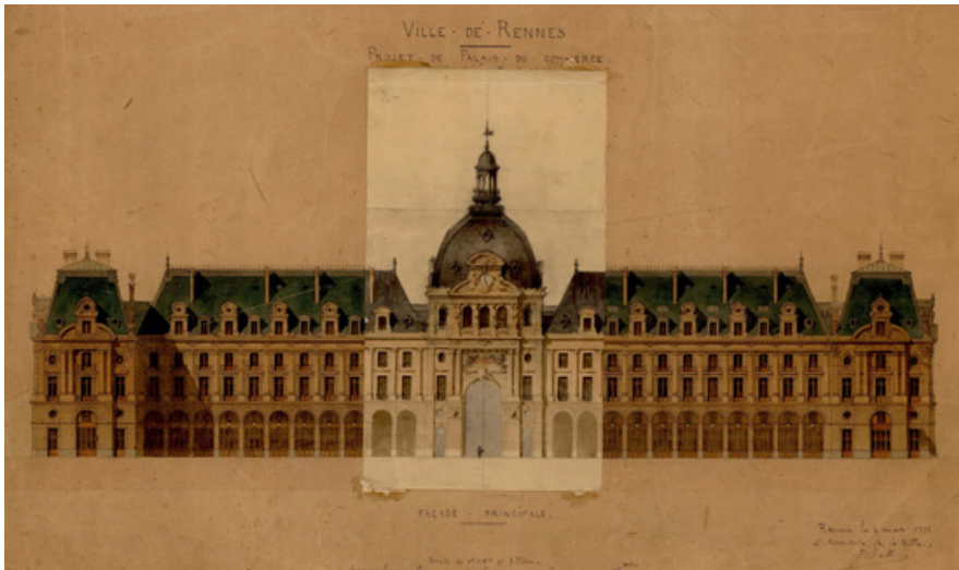
Fig. 4. Projet du Palais du Commerce. Élévation de la façade principale avec projet de variante du pavillon central, par Jean-Baptiste Martenot, 4 mars 1885. Arch. Mun. de Rennes 2F1551-1.
