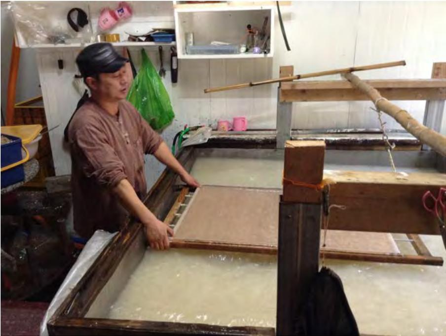
**Fig. 16.** Fabrication d'une feuille selon la fabrication traditionnelle coréenne © association Correspondance.
