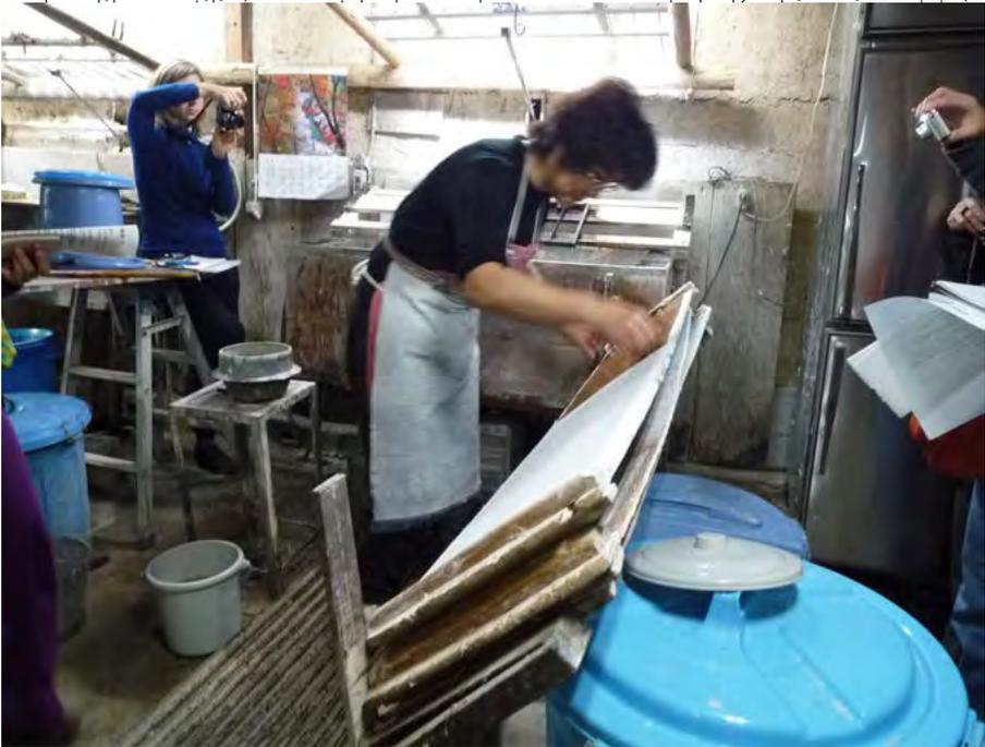
Fig. 9. Couchage de la feuille de *misugami* sur une planche en bois selon la technique *subuse* © association Correspondance.
