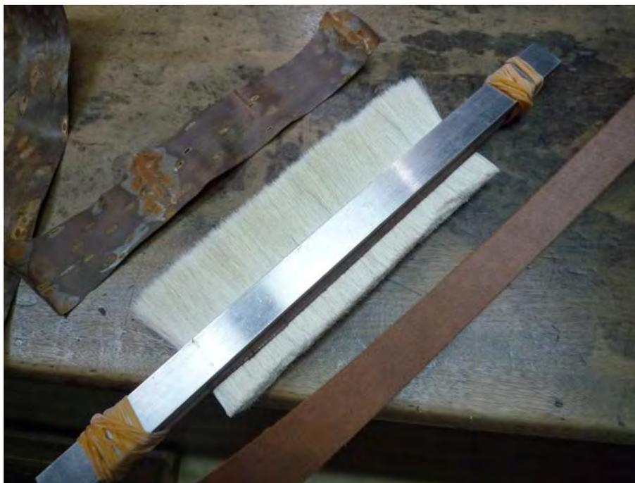
**Fig. 3.** Préparation des poils présentés avec les matériaux de gainage : bande de papier japonais imprégnée de jus de kaki fermenté et écorce de cerisier © association Correspondance.
