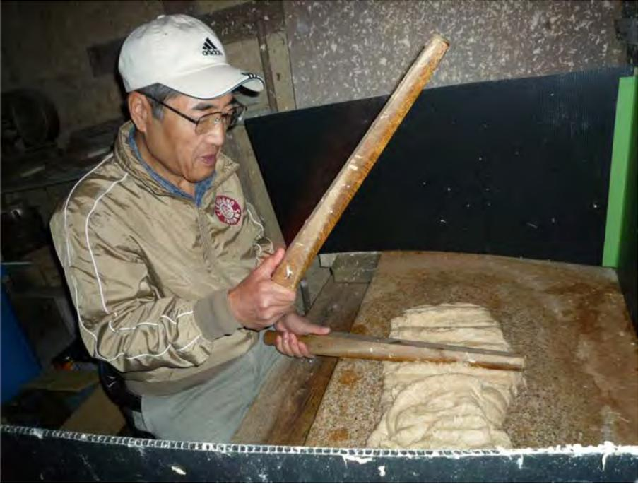
Fig. 11. Battage des fibres de *kozo* sur une planche en bois © association Correspondance.
