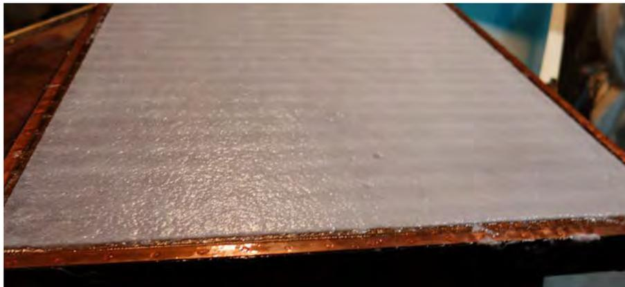
**Fig. 4.** Feuille de papier en cours de fabrication ; détail du matelas fibreux récolté sur la forme avant couchage et pressage © Moulin du verger (Le Moulin du verger, Papeterie, 16400 Puymoyen, <http://www.moulinduverger.com> [consulté le 11 mai 2016])
