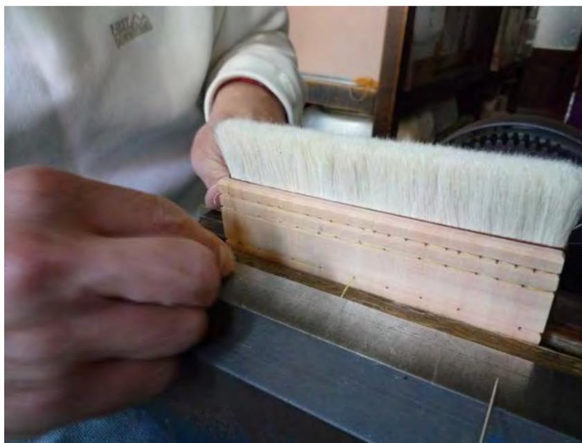
Fig. 5. Couture pour la fixation des poils dans le manche © association Correspondance.
