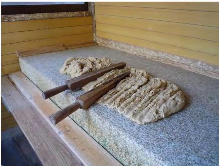
**Fig. 6.** Battage des fibres de *kazo* sur une pierre de granit © association Correspondance.
