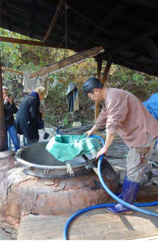
**Fig. 12.** Le papetier monsieur Jang Ji Bang filtrant des cendres pour l'obtention de l'eau de cuisson des fibres © association Correspondance.
