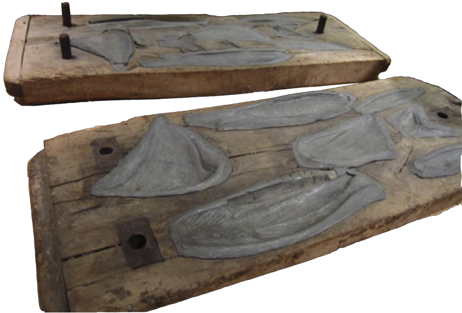
Fig. 4. Moule en bois habillé d'une feuille de métal, mis au point par Auzoux; collections du Musée de l'écorché d'anatomie de Le Neubourg © Marion Gouriveau
