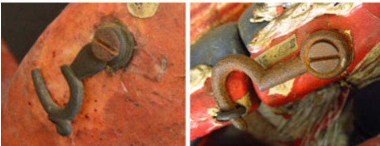
Fig. 16. Crochet en laiton (à gauche), crochet en alliage ferreux (à droite) présents sur le grand modèle d'homme d'1 m 82; collections du Musée de la médecine de Bruxelles © Marion Gouriveau
