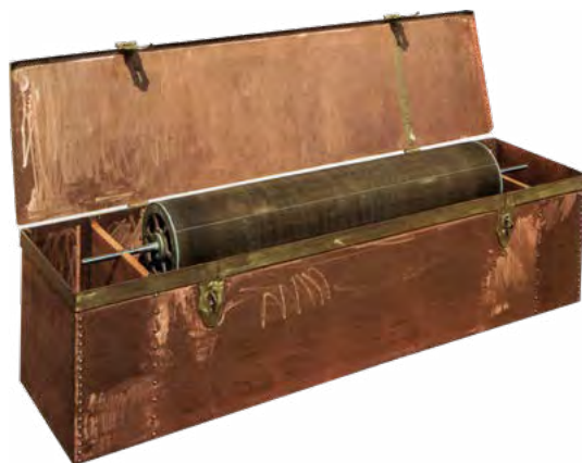
Fig. 11. Rouleau filigraneur des collections de la Banque de France servant à la confection des filigranes.
