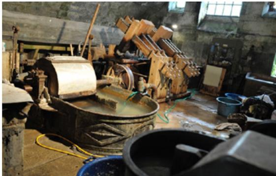
**Fig. 8.** Au premier plan un cylindre hollandais de laboratoire Lamhort 1937. Au deuxième plan un cylindre hollandais du dernier tiers du XIX<sup>e</sup> siècle. Au troisième plan deux creux de pile à maillets, 2007 © Gérard Martron
