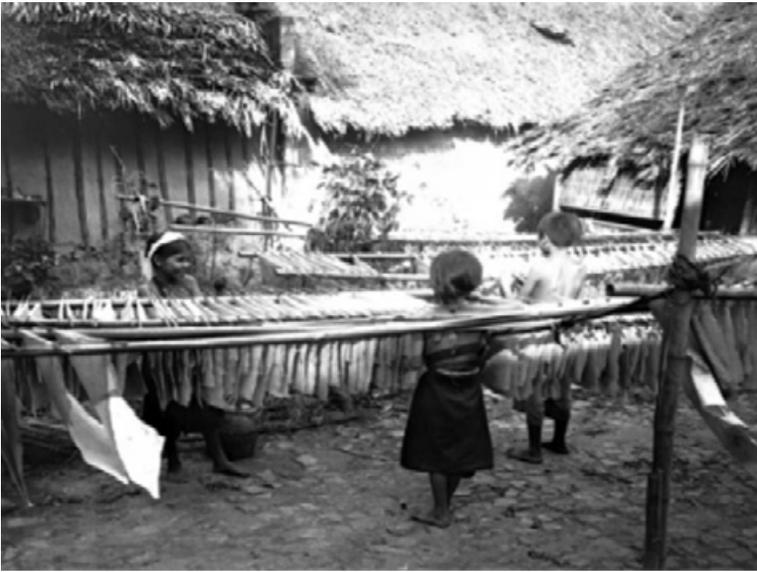
**Fig. 21B.** Séchage à l'air des feuilles de papier. IM-IT62-893 © Établissement de communication et de production audiovisuelle de la défense-Paris
