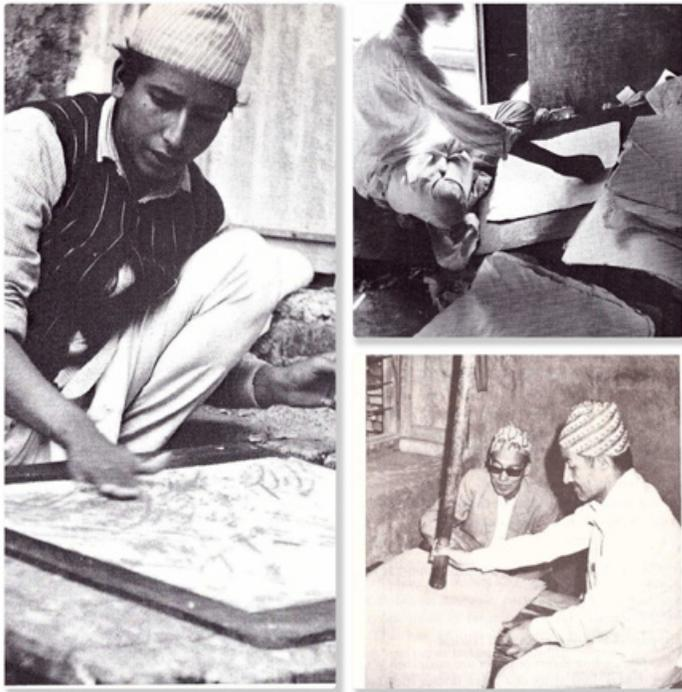
**Fig. 7.** Haut et bas : Finitions : polissage sur une planche avec un outil lisse ©Jesper Trier, © Gajurel et Vaidya - Droite : encollage avec une pâte d'amidon avant polissage © Trier
