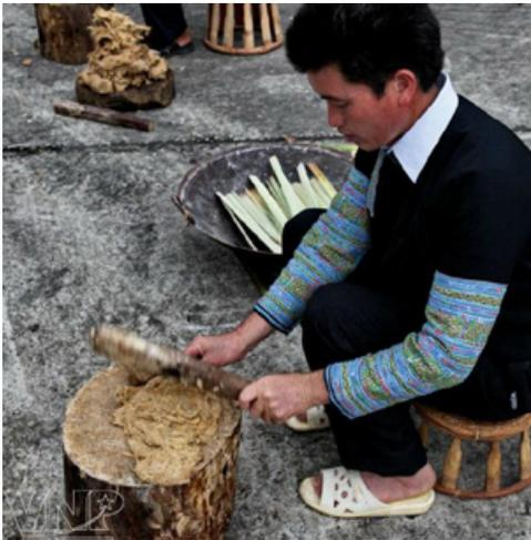
Fig. 24A. Martelage des fibres © VNP.
