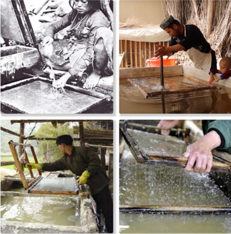
**Fig. 5.** Les deux principales méthodes de formation de la feuille. Haut : forme flottante, la pâte à papier est dispersée à la main (à gauche) ©Trier ou à l'aide d'un outil (à droite) ©Josh Summers. Bas : Forme plongeante japonaise à gauche et chinoise à droite © [www.cnnnews.com](http://www.cnnnews.com).
