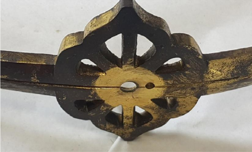
**Fig. 2.** Partie démontée d'un lustre en alliage cuivreux datant du XIX<sup>e</sup> siècle permettant d'observer au centre la zone de vernis or intacte. (J. Schröter)
