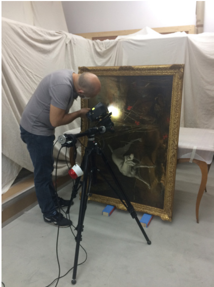
Fig. 1. Préparation de l'installation sans contact de l'instrument de fluorescence X ELIO pour les analyses sur Chien et perdreaux dans la réserve du musée de la Chasse et de la Nature (à gauche, © C2RMF, Johanna Salvant). Le détail de la tête de l'instrument ELIO est montré à droite (©C2RMF, Anne Maigret).
